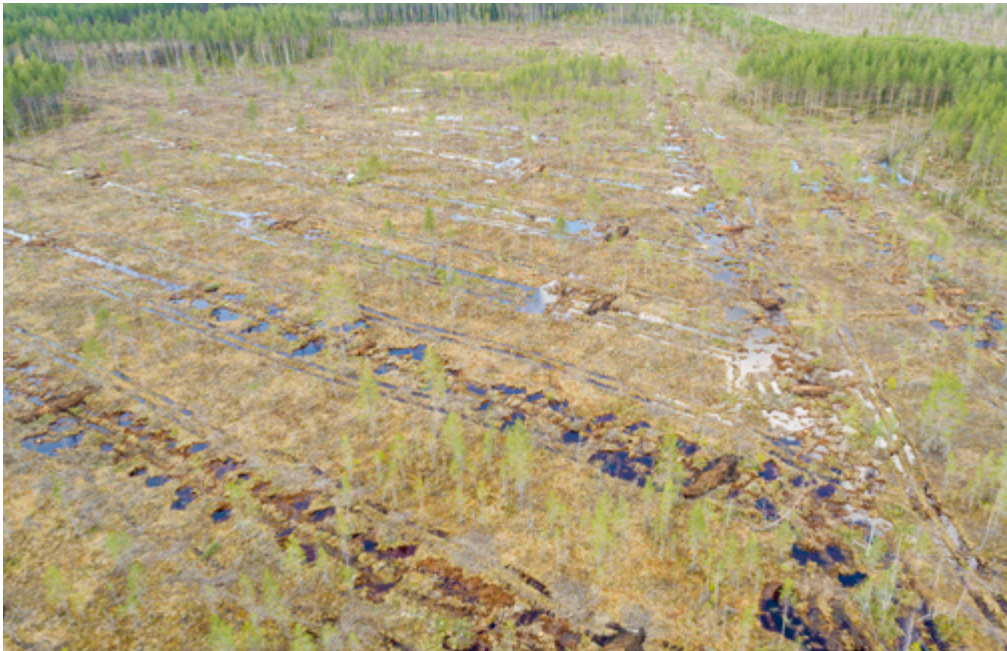
Onnistuneessa ennallistamisessa suoveden pinta nousee, ja pintavedetkin ohjautuvat ojalinjoilta tasaisesti suolle. Tämä vaatii riittävästi tarpeeksi järeitä patoja ja ojien tukkimista. Kuva: Jussi Kirmanen
